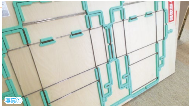
▲こちらは接着加工なしで組み立てる「N式化粧箱」の抜型です。厚さ約1.8cmのベニヤ板に化粧箱の抜型が2面分、取り付けられています。
