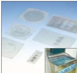
▲製版データをもとに製版機で樹脂版を作成。これにインクをのせて印刷していきます。
